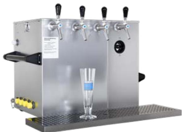
Tireuse à eau sur comptoir (2/3 PS), inox, 2 ou 4 lignes, sans robinet ni bac d'égouttage. Débit pour événements de grande envergure. Puissante grâce à la commande de détendeur. Avec moteur d'agitation et thermostat manuel. Poignées plastiques solides sur les côtés pour un transport facile. Avec réfrigérant R 290 : écologique et économe en énergie. Capacité du réservoir d'eau : 27 litres.
