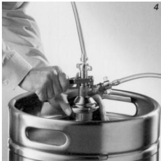
Zum Abnehmen des Zapfkopfes ziehen Sie den Hebel nach oben und nehmen den Zapfkopf vom Verschluss. Danach Schutzkappe wieder aufsetzen.
