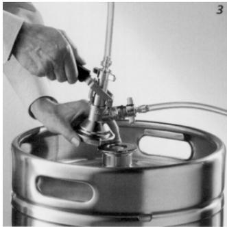
Hebel nach unten drücken. Dadurch werden die Ventile für Bier und CO<sub>2</sub> geöffnet, und es kann gezapft werden. Wenn der Zapfkopf einen Absperrhahn hat, muss dieser nach dem Aufsetzen des Zapfkopfes geöffnet und vor dem Abnehmen geschlossen werden.
